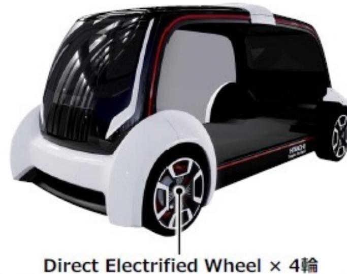
図2 「Direct Electrified Wheel」をホイール内部に
